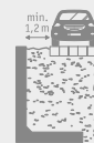
E | Verkehrslast bis p = 5 \text{ kN/m}^2 , mit Verdichtungs-erddruck evh = 25 \text{ kN/m}^2 , Abstand: 1,2 m (bis 155 cm Höhe)/1,5 m (ab 180 cm Höhe)
