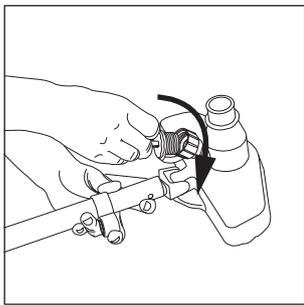
5. Ajuste sin apretar una abrazadera sobre la manguera por encima del manguito del extremo abierto de la manguera flexible.
