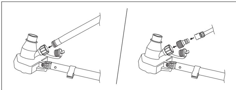
6. Deslice la manguera hacia el interior de la abrazadera de manguera.
