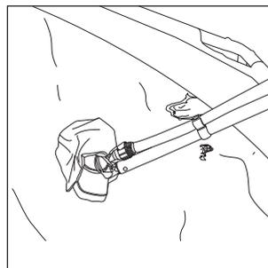
8. Abra el suministro de agua y generará una acción venturi en la aspiradora para recoger los residuos del interior de la bolsa de la aspiradora.
