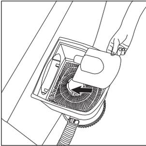
11. Coloque el extremo abierto de la manguera flexible a la boquilla de retorno y empiece a llenar la manguera con agua. Continúe llenando la manguera hasta que todo el aire del interior haya sido purgado.
