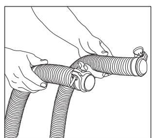
6. Enganche la manguera flexible de 1/4" a la aspiradora y apriete la abrazadera de manguera.
