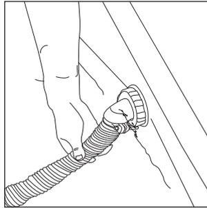
12. Con el extremo de la manguera bajo el agua, deslícelo lentamente a través de la ventana del skimmer y engánchelo por encima de la abertura del adaptador de la aspiradora.
