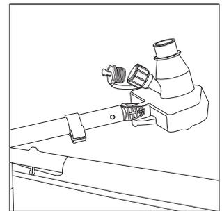
3. Encienda la bomba Skimmer, el agua empezará a fluir hacia la piscina a través de la boquilla de retorno. Mantenga la bomba funcionando durante el proceso.
