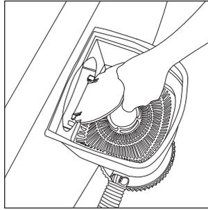
10. Ponga el adaptador de la aspiradora por encima del filtro y presione hacia abajo. Se generará un vacío y mantendrá el adaptador de la aspiradora en su lugar.
