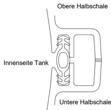
Zur Verbindung der Schalen werden die Schnellverbinder abwechselnd nach rechts und nach links angebracht. Dazu wird im ersten Schritt jeder zweite Verbinder von Hand vorjustiert und anschließend mit einem Hammer und einer Holzunterlage befestigt. Zur leichteren Montage sollten die Verbinder an den Innenkanten eingefettet werden. Die Verbinder rasten in der Endposition ein.
