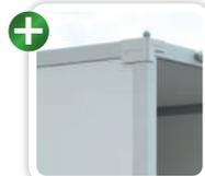
stabiler Kofferaufbau mit breitem ALU-Rahmen und Eckverstärkung, wasserdicht verklebt.
