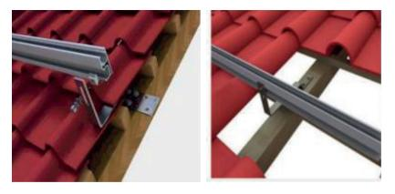
Die Schienen werden mit den beiliegenden Schrauben (inkl. Flachbuchse und Aluminium Nut) befestigt. Der Abstand zwischen den beiden Schienen sollte zwischen 65%~75% der Modullänge liegen.
