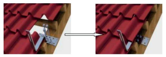
Jeder Haken wird mit jeweils 3 Schrauben befestigt. Nehmen Sie den benötigten Ziegel heraus und montieren dann den Haken wie auf der Abbildung. Danach können Sie den Ziegel wieder verlegen.
