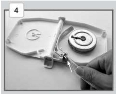
Führen Sie das Gurtband durch die Öffnung auf der Seite der Rolle. Vorweg mit dem vorgefertigten Schlitz aus Schritt 2.
