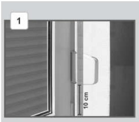
Bitte schneiden Sie das Gurtband 10cm unter Ihrem alten Aufschraubwickler ab, bei Neuinstallation halten Sie den Aufschraubwickler an die zukünftige gewünschte Position und schneiden 10cm unterhalb des Gurtwicklers das Gurtband ab.
