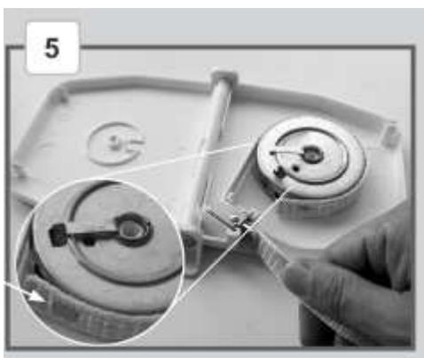
Fädeln Sie das Gurtband mit dem Schlitz in die dafür vorgesehene Halterung auf der silbernen Federrolle auf. Bringen Sie leichten Zug auf das Gurtband, damit sich das Band ordentlich festziehen kann.
