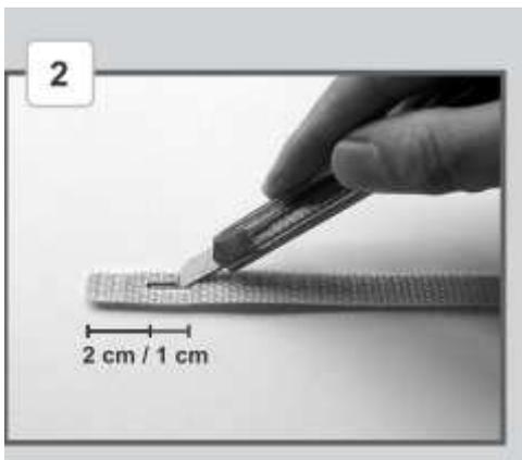
Schneiden Sie mit einem scharfen Cuttermesser einen ca. 1 cm langen Schlitz in der Mitte des Gurtbandes. Achten Sie bitte auf einen mind. Abstand von 2cm zum Ende des Gurtbandes.
