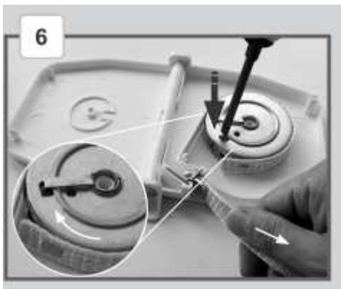
Halten Sie mit der einen Hand das Gurtband auf Spannung und ziehen die Rolle leicht auf – drücken Sie mit einem Schraubenzieher die Sicherung (kleines Metallblättchen auf der Rolle) einfach in das Gehäuse ein.
