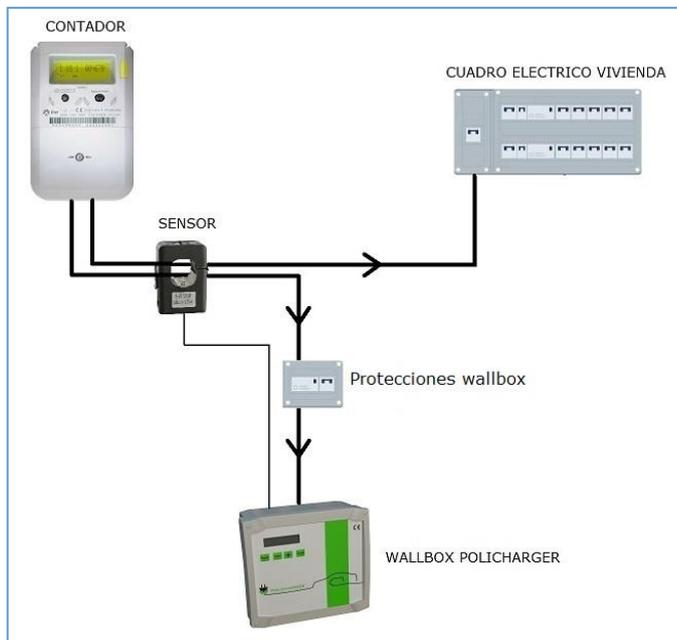
En este ejemplo la acometida del Wallbox proviene del contador a través de un cuadro de protecciones dedicado. En este caso el sensor tiene que colocarse abrazando la línea que alimenta el cuadro general, así como la acometida del Wallbox.
