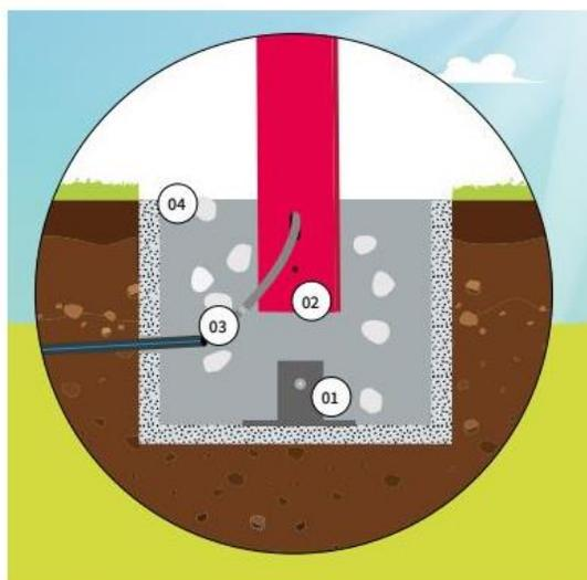
01 Fije la base metálica a la caja de hormigón o al ladrillo de hormigón.
