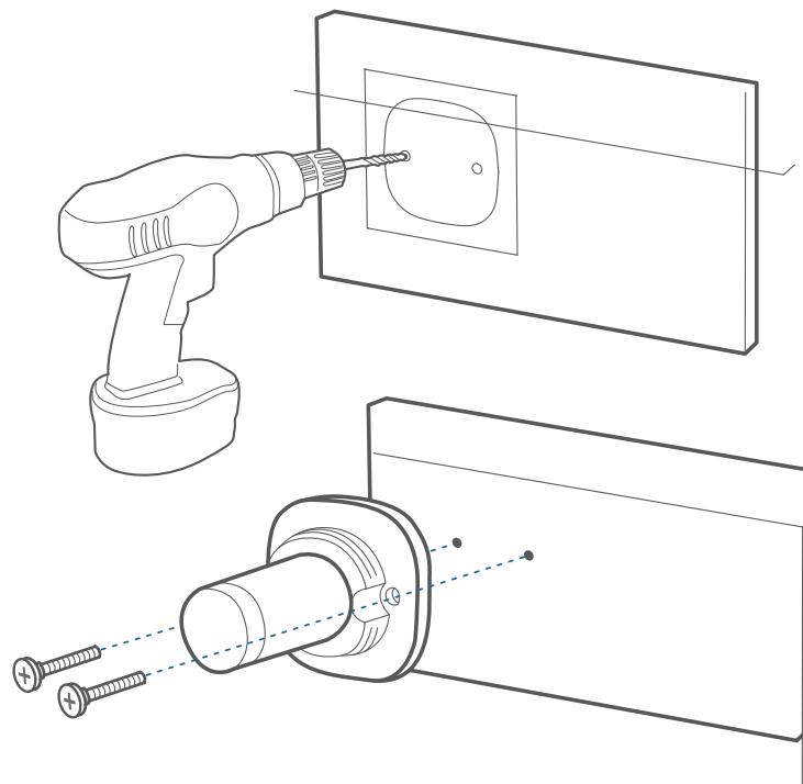
3. Čvrsto zavrnite gumb montažnog nosača u montažnu rupu.
