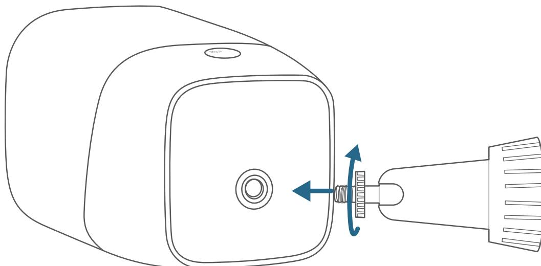
4. Držite i pričvrstite kameru na montažni nosač. Zakrenite kameru kako biste prilagodili smjer i provjerite je pomoću live streama, kojem možete pristupiti u aplikaciji.
