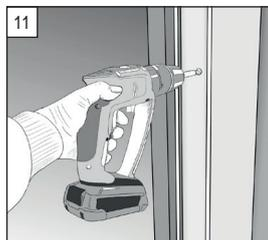
11 Befestigen Sie den Rahmen mit Rahmendübeln/ Montageschrauben. Hängen Sie dann den Flügel wieder ein. Achten Sie darauf, dass der Flügel vollständig am Rahmen anliegt. Fixieren Sie den Rahmen mit Keilen.
