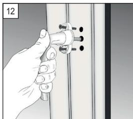
12 Montieren Sie nun den Beschlag und ggf. auch den Profilzylinder. Achten Sie darauf, dass beim Bohren für die Befestigung weder das Schloss noch andere bewegte Teile beschädigt werden.
