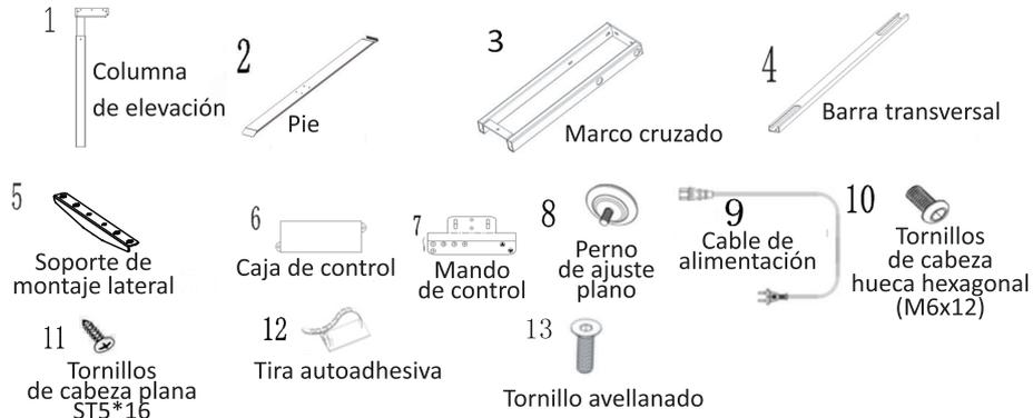
Además de los tornillos autorroscantes y la arandela del panel de montaje, todos los demás paquetes de tornillos son de repuesto, téngalo en cuenta.
