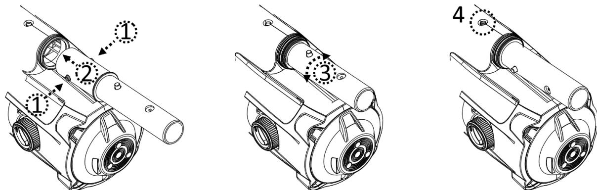
Gurnite teleskopsku šipku na spojku teleskopske šipke. Nastavite pritiskati bočne klinove spojke i teleskopske šipke sve dok klinovi spojke ne škljocnu u rupe na šipki.
