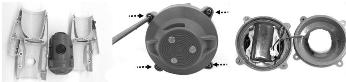
4. Upotrijebite križni odvijač da otpustite vijak na kutu ravne potporne ploče. Izvucite ploču pomoću stezaljke kako biste oslobodili tiskanu pločicu i njezine priključke.
