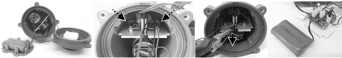
5. Pronađite središnji priključak kao što je prikazano – pritisnite kopču i izvucite ga. NAPOMENA: Odmah omotajte priključak izolacijskom trakom kako biste spriječili kratki spoj od kontakta dvaju žičanih spojeva.
