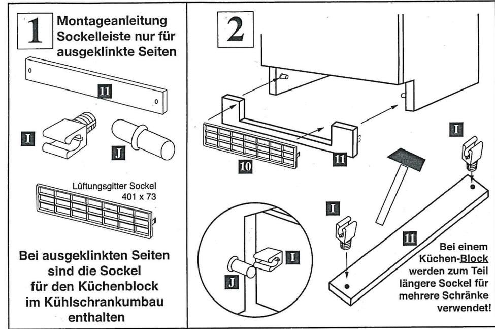
**Lüftungsgitter für den Sockelausschnitt beim Kühlschrank bzw. bei der Kühl-Gefrierkombi**
