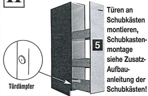
Türen an Schubkästen montieren, Schubkastenmontage siehe Zusatz-Aufbauanleitung der Schubkästen!
