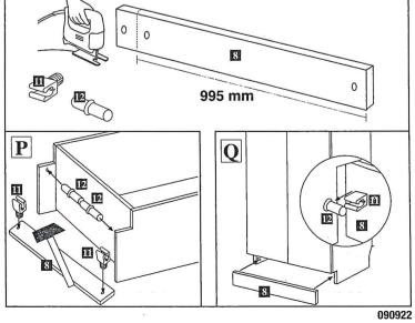
Montage-Anleitung - Sockelleiste für ausgeklinkte Seiten
