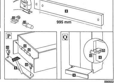
Montage-Anleitung - Sockelleiste für ausgeklinkte Seiten
