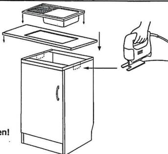
**HINWEIS!** Bei der Montage des Einlassbeckens Dichtungsband von unten ringsum einkleben. Die Befestigungsklammern nur mit einem Handschraubendreher festziehen!
