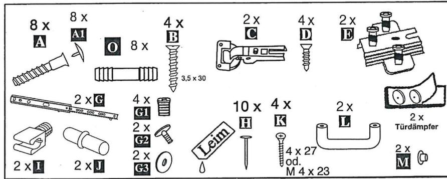
Technische Änderungen vorbehalten. Einzeltelle vor Montagebeginn prüfen. Kein Schadensersatz bei unsachgemäßer Montage sowie mit fehlerhaften Teilen.
