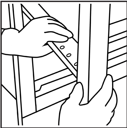
3. Una los travesaños a los laterales del carro.
