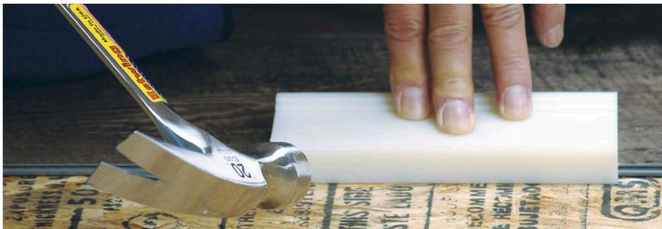
Mit einem Qualitäts-Schlagklotz wird die fachmännische Verlegung noch einfacher! Eine praktische und professionelle Hilfe bei der Verlegung von Fußböden mit Click-Profilen.
