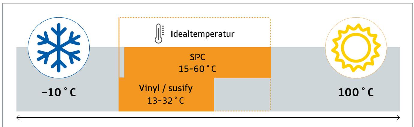
Die maximale Oberflächentemperatur von 60 °C bei SPC-Böden und von 32 °C bei Vinyl-/susify-Böden darf nicht überschritten werden. Außerdem muss ein sehr schneller Aufheizvorgang vermieden werden.
