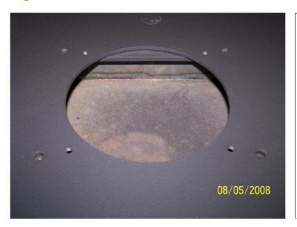
Der Abgasstutzen wird in den äußeren Gewindelöchern verschraubt. Hierzu werden selbstformende Schrauben verwendet, die ein metrisches Gewinde formen.
