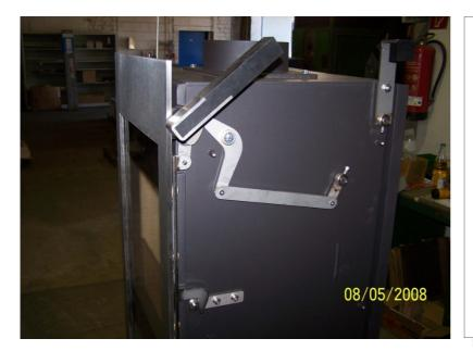
Über das Abgasgestänge sind der Türgriff und die Abgasklappe miteinander gekoppelt.
