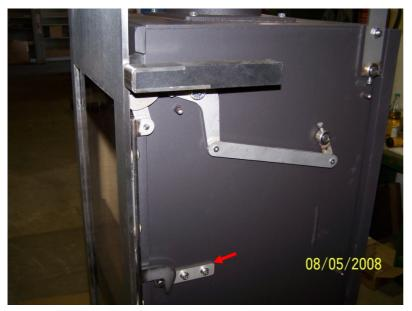
Bild zeigt Griff in TwinFire-Stellung. Zuerst wird die Türabdichtung über die Rollenbleche eingestellt. Siehe Pfeile.
