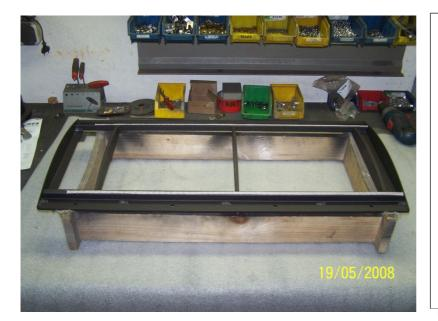
Türrahmen gewölbt mit Dichtung Durchmesser 6 mm bekleben
