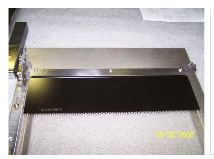
Scheibenhalter und Aushebesicherung korrekt montiert.
