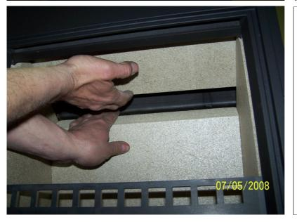
Vermiculite oben Deckel anheben und Vermiculite oben Hinten an die Rückwand anlegen.
