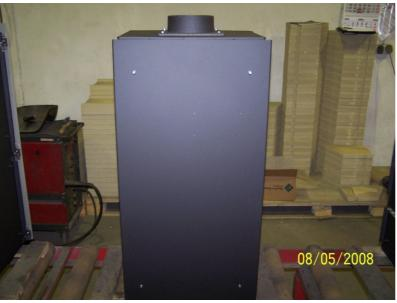
Sollten die Abgänge umgebaut werden, so ist darauf zu achten, dass die Schrauben auf der Oberseite auch dort verbleiben. Sie haben eine andere Länge als die Schrauben auf der Rückseite des Ofens, an der Pos. für den Rauchgasstutzen.
