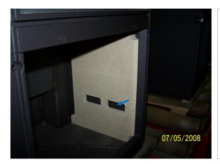
Oberteil Vermiculite unten re in Brennraum unten einstellen.
