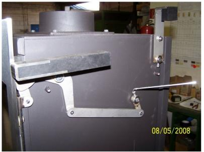
Der Türgriff wird leicht geöffnet, wenn die Abgasklappe gleichzeitig in die Dichtung gedrückt wird.
