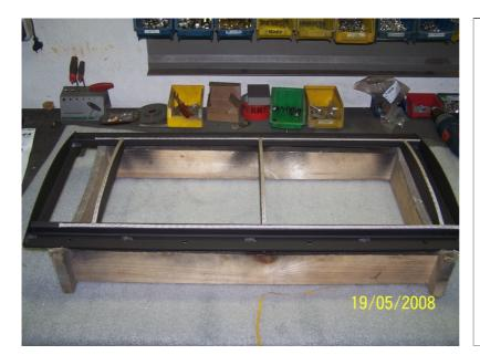
Türrahmen gewölbt mit korrekter Beklebung.
