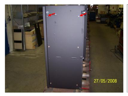
Befestigung für Blechverkleidungen mit 4 Haken durch je 4 Schrauben mit Unterlegscheiben auf jeder Seite des Ofenkorpus.
