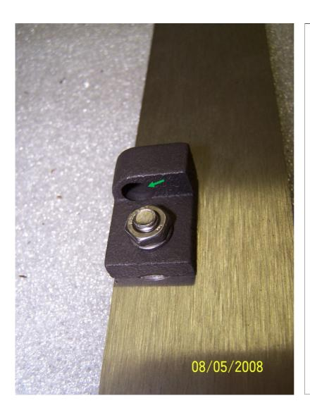
Scharnier Tür ohne Schlitz wird an der Tür an den unteren beiden Positionen verwendet.
