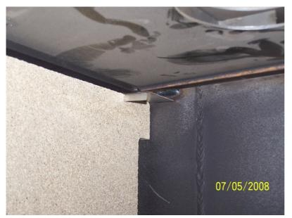
Halteblech Vermiculite unten auf Bauteil Vermiculite unten li aufsetzen.
