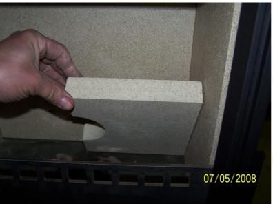
Schamotte oben Boden auf Bauteil Doppelboden ablegen. Die Fase muss nach vorne und nach
