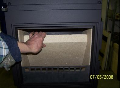
Vermiculite oben hinten in Brennraum oben einsetzen.
