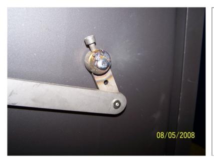
Die werksseitige Einstellung wird mittels eines Schweißpunktes zwischen Abgaswelle und Abgasgestänge gesichert.
