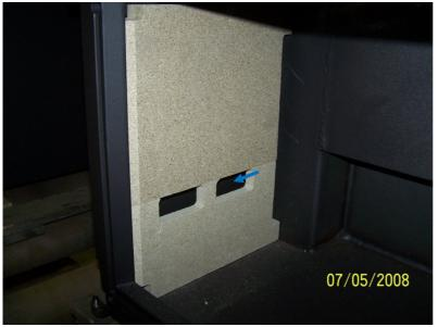
Oberteil Vermiculite unten li in Brennraum unten einstellen.
