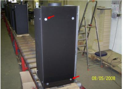
Diagonal versetzte Verwendung der Zierschraube mit Bund.
