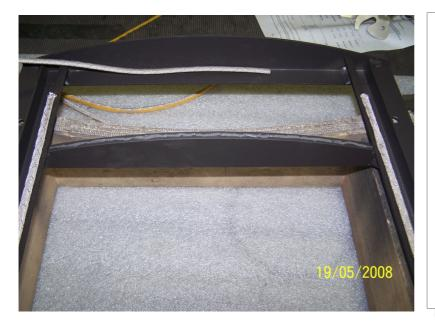
Kleber dünn und gleichmäßig auftragen auf Querprofil zwischen.
