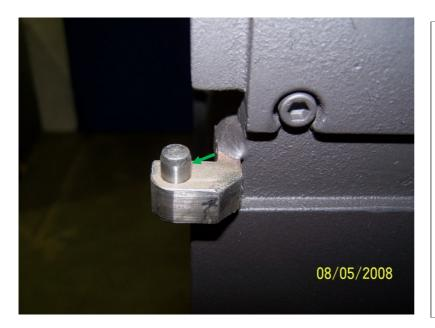
Scharnier Korpus an Korpus fest verschweißt. Türbolzen eingepresst.
