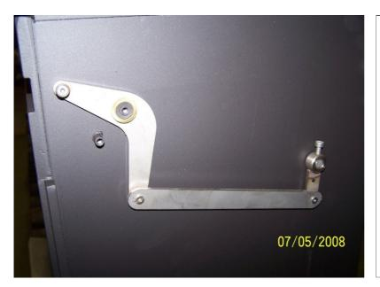
Bild zeigt korrekte Lage der Tellerfeder Pos. 3.
