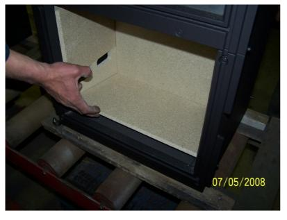
Vermiculite unten Boden in Brennraum unten einsetzen.
