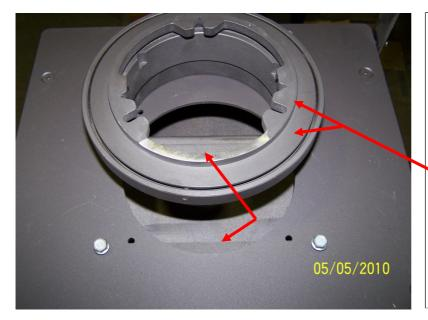
Abgasstutzen drehbar muss mit geschliffener Kante an den Flachstahl 6 mm dick angelegt werden.
