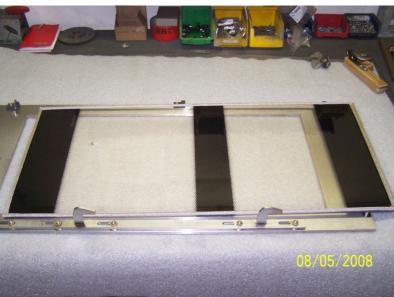
Scheibe Robax eindichten mit Dichtung Durchmesser 6 mm. Beklebung auf der nicht hinterdruckten Seite (vorne)
