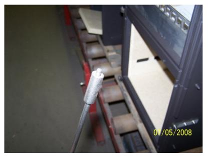
Schraube Sechskant M5x8 verzinkt Pos. 6 in Steckschlüssel einsetzen.
