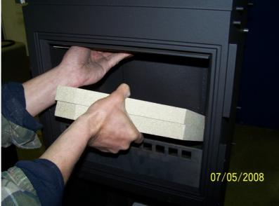
Vermiculite oben Deckel anheben und Vermiculite oben li / re in Brennraum oben einstellen.
