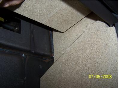
Vermiculite oben neben Deckel auf Bauteil Vermiculite oben re ablegen und seitlich an den Korpus schieben.
