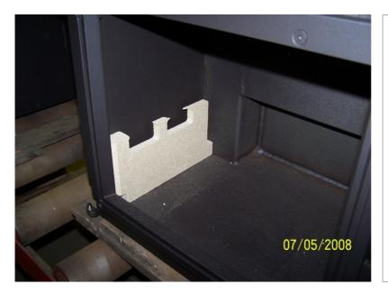
Unterteil Vermiculite unten li in Brennraum unten einstellen.
