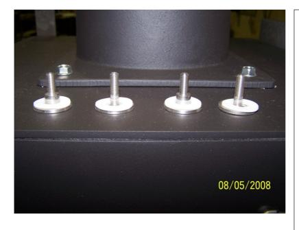
Die Glasverkleidungen werden durch Zierschrauben an dem Korpus befestigt.
