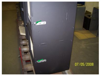
Bild zeigt beide Rollenbleche in korrekt montierter Lage.
