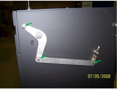
Bild zeigt korrekte Lage und korrekte Verschraubung des Abgasgestänges.
