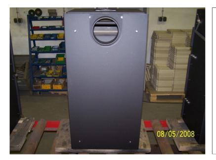
Isoblech Abgang hinten / Abgang oben wird mit 4 Schrauben auf der Rückseite des Korpus montiert.
