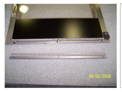
Scheibenhalter unten mit Dichtung Durchmesser 6 mm versehen.
