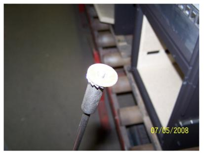
Fächerscheibe 5x18x2 verzinkt Pos. 5 auf Schraube aufsetzen.
