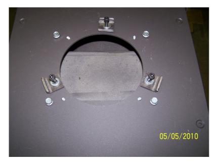
Abgasstutzen drehbar mit zugehörigen Innensechskantschrauben M6x20 und Schellen am Deckel verschrauben. Abgasstutzen drehbar x5/x8
