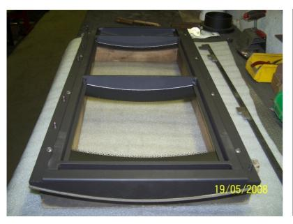
Bild zeigt korrekt verschraubten Türrahmen gewölbt mit Türblende gewölbt.
