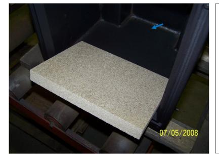
Vermiculite unten Boden in Brennraum unten einsetzen.
