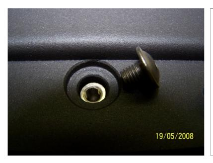
Verschrauben von Türblende gewölbt und Türrahmen gewölbt mit Linsenkopfschraube mit angepresster Scheibe V2A.
