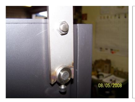
Federndes Druckstück an TwinFire-Tuner, sowie Welle für TwinFire-Tuner werden abgeschliffen, um bei Glasverkleidung ein Schaben an der Hinterdruckung zu vermeiden.
