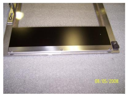
Scheibenhalter montieren mit Zylinderschraube mit Innensechskant M4x6 Edelstahl.
