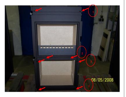
Der Guss-Frontrahmen ist an 8 Stellen mit dem Korpus verschraubt. 2 Schrauben liegen hinter der Dichtung des unteren Frontrahmens.
