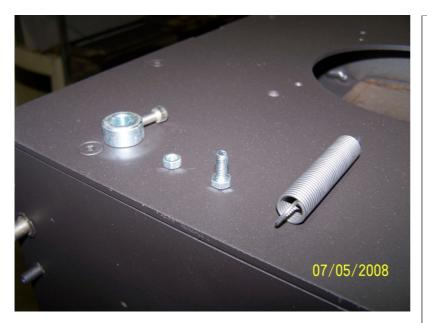
Der TwinFire-Tuner wird auf der rechten Ofenseite durch einen Federmechanismus ausbalanciert.
