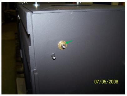
Bild zeigt korrekte Lage für Messingscheibe Pos. 1
