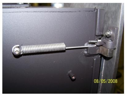
Türfeder in Federlasche einhängen und mit Linsenkopfschraube M5x8 Edelstahl sichern.
