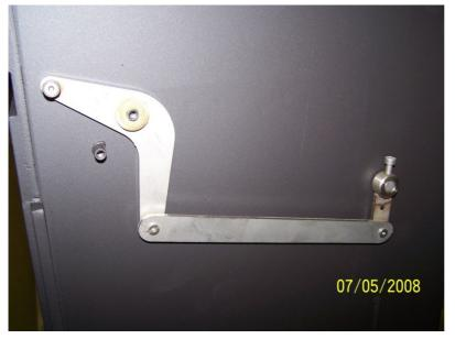
Bild zeigt korrekte Lage der Messingscheibe Pos. 2
