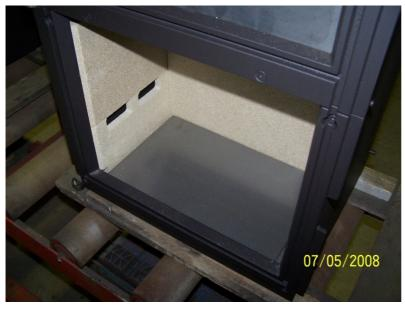
Bild zeigt korrekte Lage für Bauteil Einlegeblech unten Boden x8.
