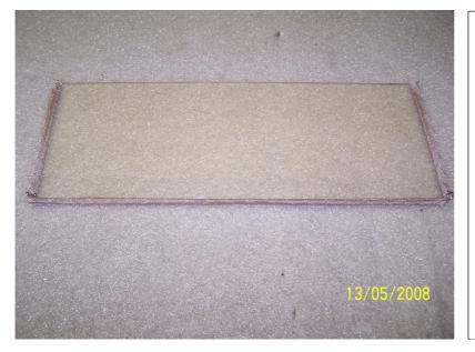
Stehrost Robax Glas abdichten Dichtung Durchmesser 6 mm selbstklebend.
