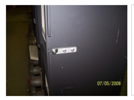
Bild zeigt oberes Rollenblech in korrekt montierter Lage.
