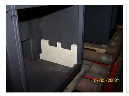
Unterteil Vermiculite unten re in Brennraum unten einstellen.
