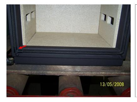
Die gefederte Dichtung (Art.-Nr.: 9000067) wird umlaufend eingesetzt. Die Stoßkante liegt immer unten links in der Ecke.
