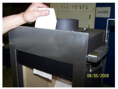
Dichtprüfung umlaufend an der Türdichtung mittels Papiertest.
