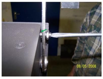
Federndes Druckstück wird leicht gegen Korpus geschraubt und mit Mutter M8 flach gekontert.
