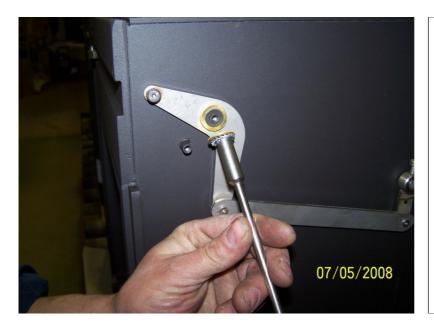
Messingscheibe, Fächerscheibe und Sechskantschraube mit Steckschlüssel an Korpus verschrauben.
