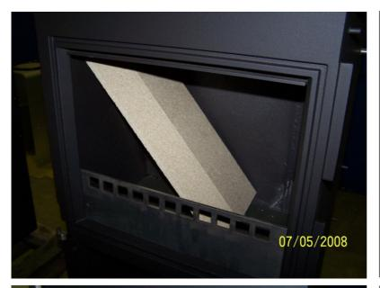
Vermiculite oben Deckel diagonal in Brennraum oben einstellen.
