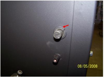
Lagerbuchse für TwinFire-Tuner-Welle
