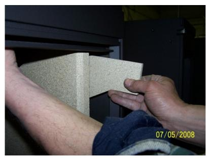
Vermiculite oben neben Deckel seitlich an Vermiculite oben li / re vorbei schieben.
