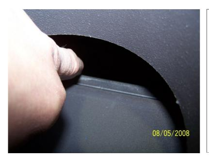
Die Abgasklappe wird durch Handkraft in die Dichtung, gegen den Innenkorpus gedrückt.
