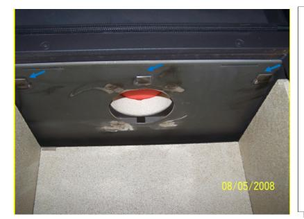
Das Scheibenspülblech wird unter dem Doppelboden eingeschoben. Hierfür sind 3 Halter vorhanden.
