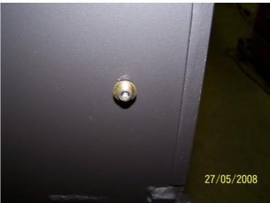
Zylinderschraube mit Innensechskant M5x8 V2A und Messingscheibe Durchmesser 5,3 in 4 Schweißbolzen je Ofenkorpusseite einschrauben.
