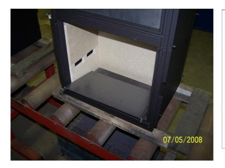
Einlegeblech unten Boden in Brennraum unten einsetzen. (Nur für x8)
