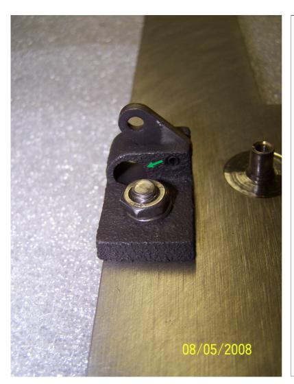
Scharnier Tür mit Schlitz wird an der Tür an der obersten Position verwendet. In den Schlitz wird die Federlasche eingesetzt
