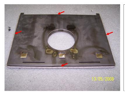
Der Doppelboden wird umlaufend mit Dichtung Durchmesser 6 mm, selbstklebend eingedichtet.
