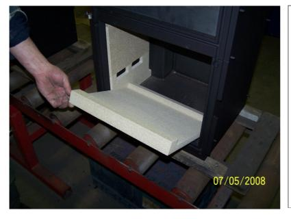
Vermiculite unten Hinten in Brennraum unten einsetzen.
