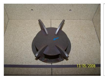
TwinFire-Rost auf Schamotte oben Boden aufsetzen. (alte Version) Der TwinFire-Rost soll aus strömungstechnischen Gründen in der gezeigten Stellung eingesetzt werden.
