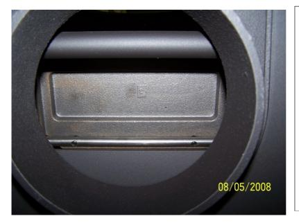
Die Abgasklappe ist auf der Abgaswelle verschraubt mit 2 Schrauben Zylinderschrauben mit Innensechskant M5x16
