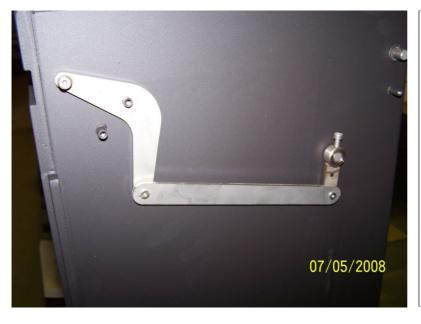
Vormontiertes Abgasgestänge an Korpus auf Welle Rauchgas und Schweißbolzen aufstecken.
