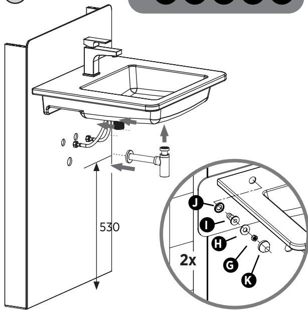
Installieren Sie die Armatur und die Ablaufgarnitur. Anschließend befestigen sie den Waschtisch am Element. Dann führen sie die Armaturenschläuche durch die beiden Löcher in der Glasplatte. Zuletzt schließen Sie den Sifon an.
