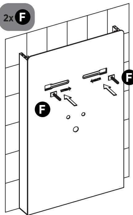
Führen Sie die Schraube zuerst entlang des Vierkantlochs in das Glas ein und bewegen Sie sie dann in Richtung des langen Schlitzes.
