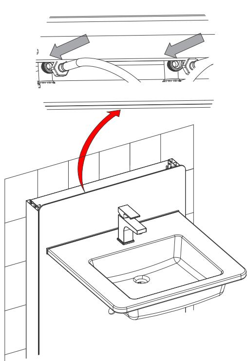
Schrauben Sie den Warm- und Kaltwasserzulauf fest an das entsprechende Eckventil.
