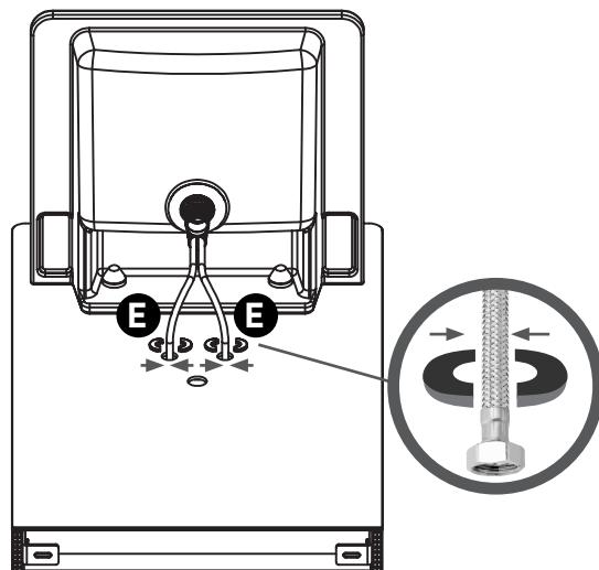
**Die beiden Abdeckungen werden über dem Wasserzulaufschlauch zusammengeführt und auf die Glasscheibe geklebt.**
