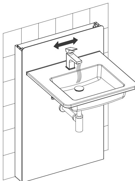
Öffnen Sie den Wasserhahn und lassen Sie abwechselnd kaltes und heißes Wasser einlaufen. Prüfen Sie, ob das Wasser aus dem Wasserhahn normal fließt und ob die Verbindung dicht ist.
