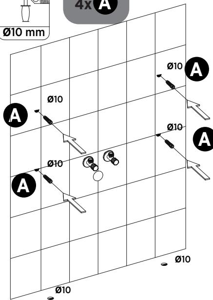
Bohren Sie die Löcher an den markierten Punkten mit dem vorgegebenen Durchmesser und setzen Sie die entsprechenden Dübel ein.
