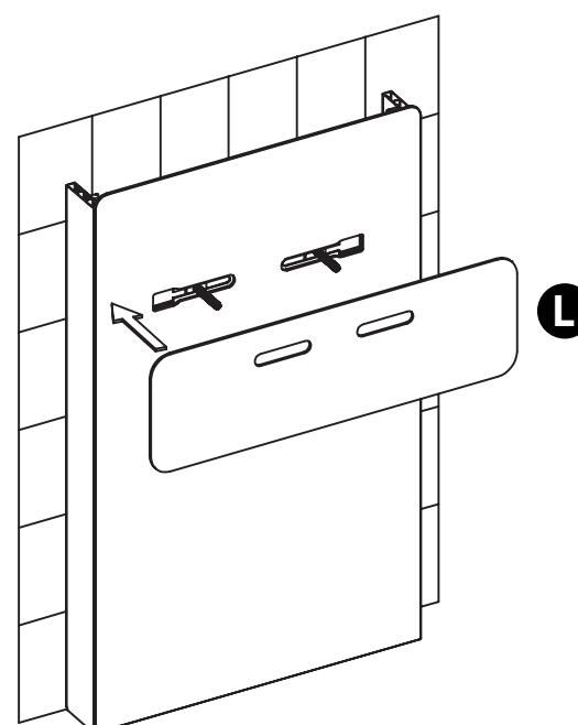
Montieren Sie den Schallschutz.
