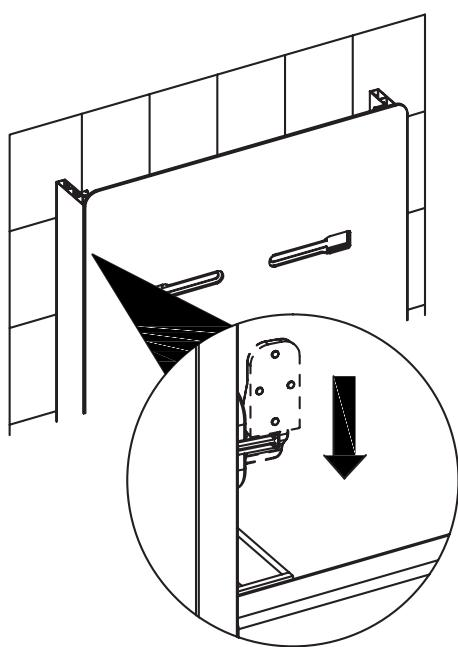
Setzen Sie das Glas plan auf den Aluminiumrahmen und schieben dann die Glasplatte nach unten, bis sie vollständig in die Halterung einrastet.
