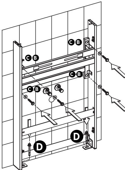
Schrauben Sie das Element mit den entsprechenden Schrauben in Wand und Boden.
