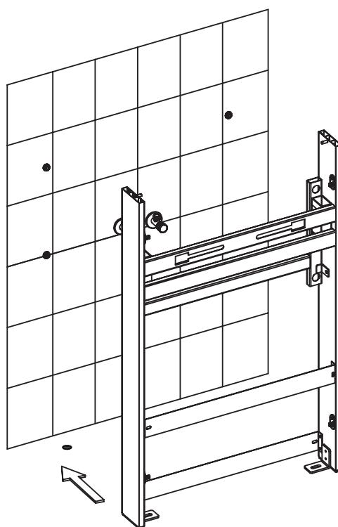
Positionieren Sie das Element wieder an der vorigen exakten Position.
