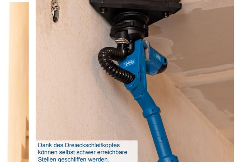
Dank des Dreieckschleifkopfes können selbst schwer erreichbare Stellen geschliffen werden.
