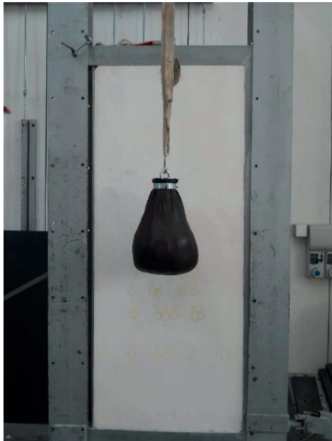
Foto de muestra sometida a prueba de impacto de cuerpo blando
