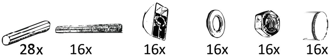
Zur Verbindung der Seitenteile mit dem Kopf- und Fußteil sowie für die Befestigung des Mittelholms am Kopf- und Fußteil.
