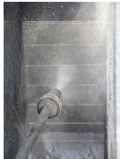
Abb. 29: Reinigung der Sieboberfläche mit Hochdruckreiniger
