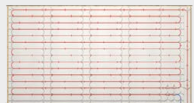
Verlegung der Heizrohre (16 mm)
