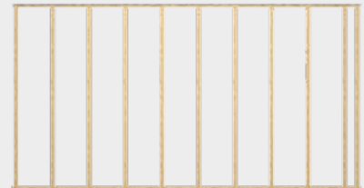
Achsabstand Unterkonstruktion max. 500 mm
