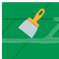
Plattenstöße bündig schleifen, eventuelle Fugen verspachteln und nachschleifen
