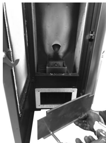
Fig. 30 - Den Inspektionsstopfen entfernen
