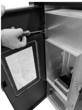
Fig. 16 - Die Schrauben abnehmen
