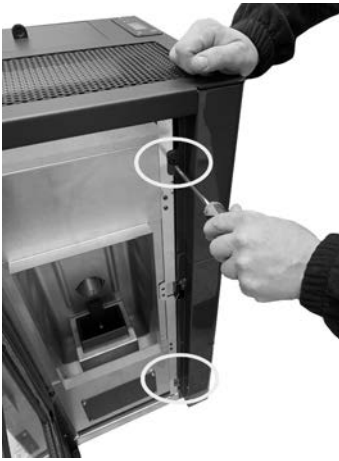
Fig. 19 - Die Schrauben entfernen
