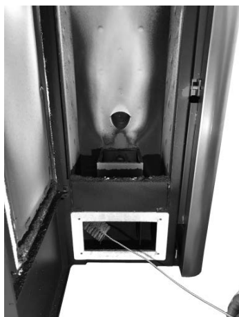
Fig. 31 - Mit einer Rohrreinigungsbürste reinigen
