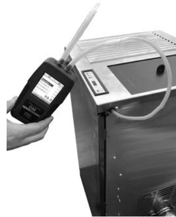
Fig. 27 - Anschluss des Digitaldruckwächters
