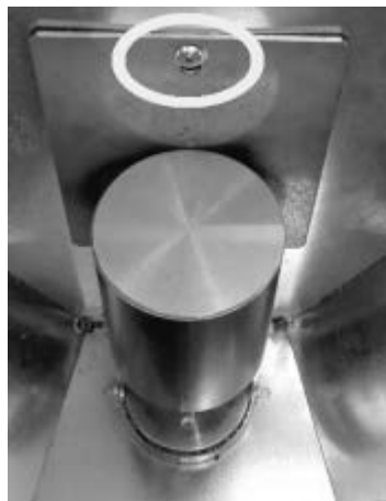
Fig. 36 - Entfernen der Schraube
