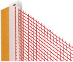
**Produkt** Kunststoffprofil der Klasse III mit Hohlkammer und angeschweißtem Textilglasgitter zur Herstellung eines schlagregensicheren Anschlusses des WDVS an Fenster und Türstock
