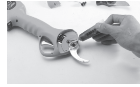
6. Al sustituir las cuchillas, es necesario añadir aceite lubricante entre ellas.
