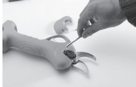
2. Desmonte los tornillos de la hebilla de retención de la tuerca de la cuchilla (este paso es fundamental).
