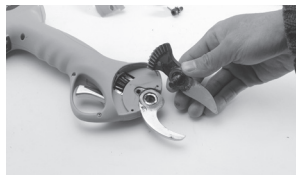
4. Démontez la goupille et retirez la lame mobile.
