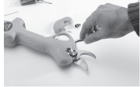
3. Desmonte la tuerca de la cuchilla.
