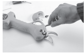
3. Retirez l'écrou de lame.
