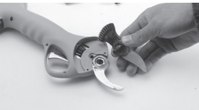
7. Sustituir la cuchilla.
