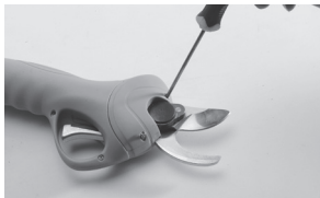
1. Retirez les vis avec un tournevis et ouvrez le couvercle.
