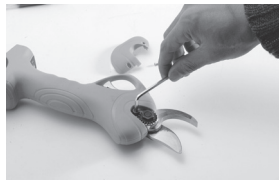
2. Retirez les boulons fixant l'écrou de la lame (cette étape est essentielle).
