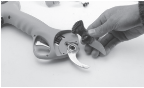
4. Desmonte el pasador y retire la hoja móvil.
