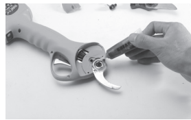
6. Lors du remplacement des lames, il est nécessaire d'ajouter de l'huile de lubrification entre les lames.
