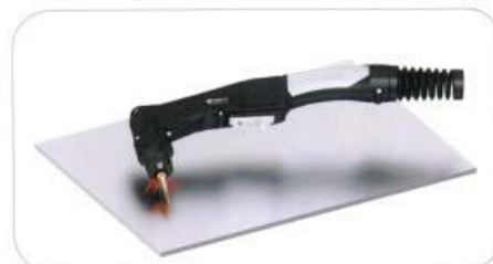
Halten Sie den Brenner zum Werkstück geneigt, betätigen Sie den Auslöser, um den Lichtbogen zu starten, und drehen Sie ihn langsam in eine vertikale Position.
