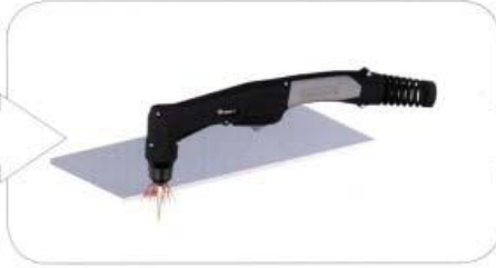
Pilot arkı başlatmak için tetiği çekin. Kesme arkı, torç ucu çalışma parçasına yeterince yakın olduğunda başlayacaktır. Ark tamamen kesene kadar kenardan kesmeye başlayın.
