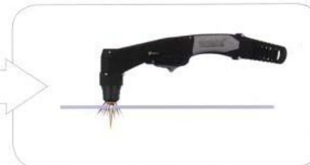
Wenn die Funken aus dem unteren Teil des Stücks herauskommen, hat der Lichtbogen das Material durchdrungen.
