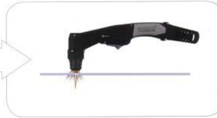
İş parçasının altından kıvılcıklar çıkarken, ark malzemeyi delip geçmiştir.
