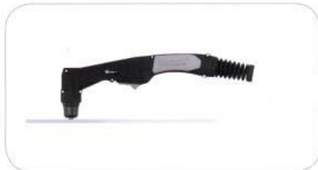
Brenner senkrecht zur Kante des Werkstücks halten
