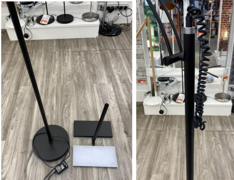
Es wird bei dieser Lampe aufgrund der strukturellen Anforderungen Federdraht verwendet, um die K/D-Montage zu erleichtern und Verpackungsmaterial zu sparen. Der Federdraht hat eine Kontraktionsfunktion, aber er muss begradigt werden, bevor er sich reibungslos in das Eisenrohr zusammenziehen kann.
