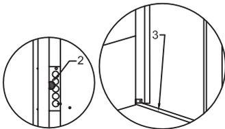
No retirar el tope de holgura (2), ni la traba inferior(3) hasta finalizar la instalación (solo en modelos dotados de este sistema).
