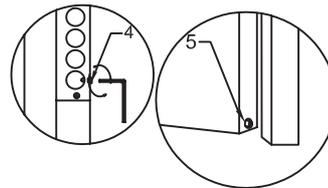
Utilizar el Regulador del Resbalón (4) para evitar el movimiento de la puerta una vez cerrada. Regular el Cepillo Guillotina / Cortavientos (5). (Solo en modelos dotados de este sistema)
