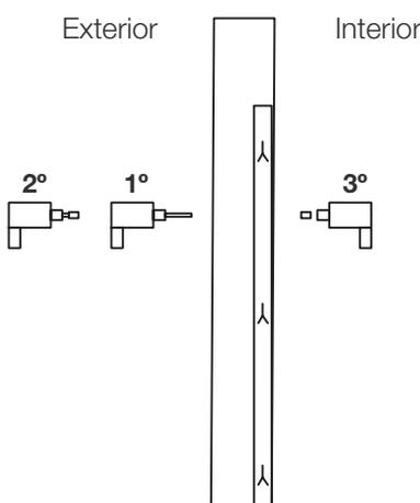
1º Utilizar una broca de máximo 6mm diám. de 100mm de largo para pasar de lado a lado la hoja. 2º y 3º Coincidiendo el centro marcado, pasar una broca bimetálica de 18mm diám. por cada lado de la hoja.
