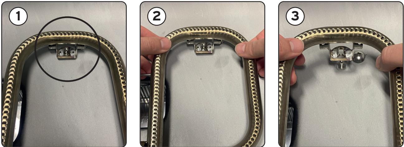
Die Brenner sind jeweils über ein **Quick-Lock System** mit dem Feuerkasten verbunden. Dadurch ist ein stabiler Halt und eine schnelle Entnahme der Brenner gewährleistet.
