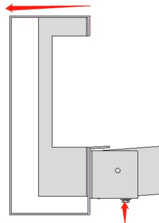
Schrauben Sie zuerst die selbstschneidende Schraube (K) in den Boden der Halterung. Dadurch wird der Rahmen gerade gezogen.
