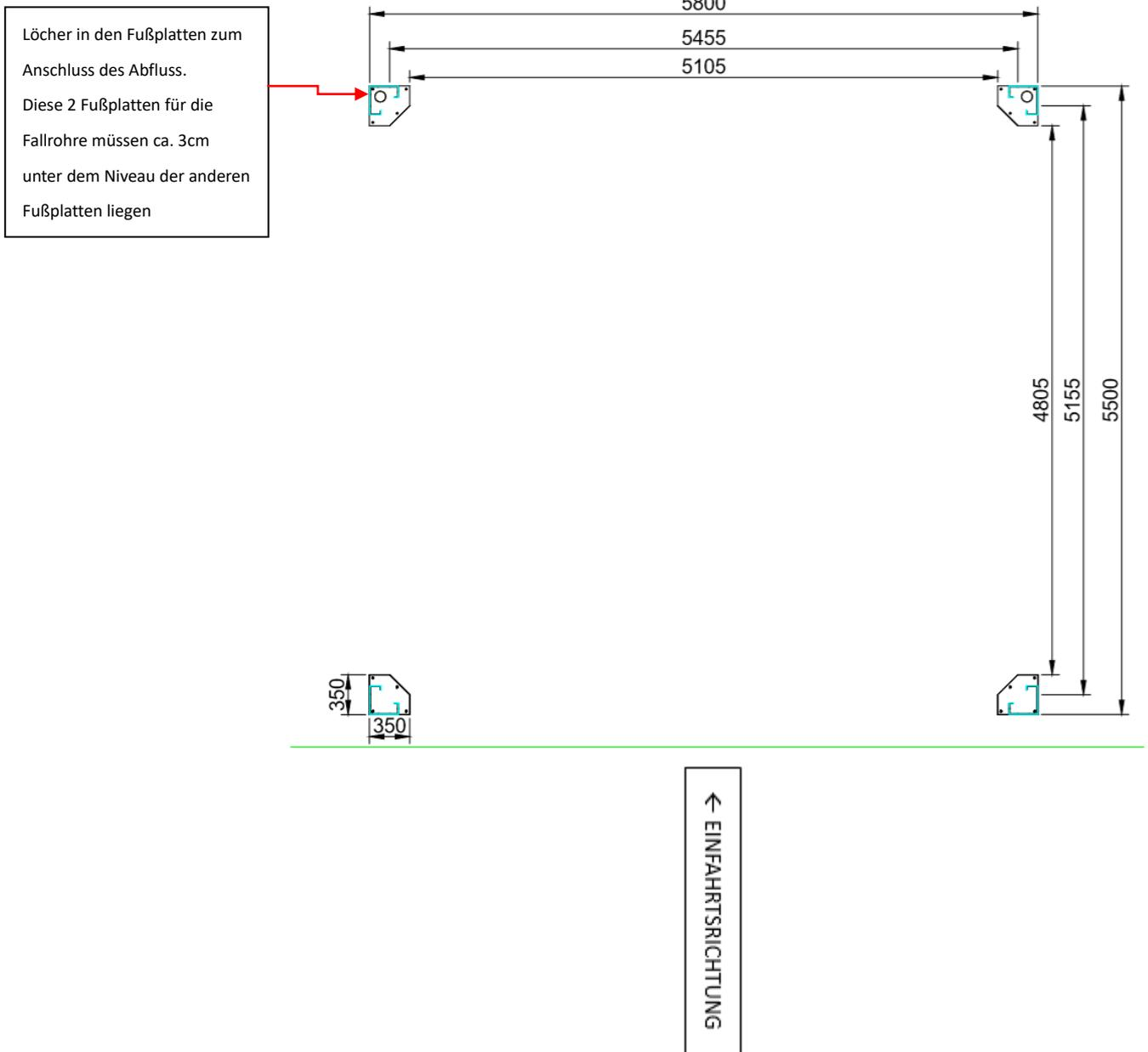
Das Fundament (minimum 50 x 50 cm Oberfläche ) gessen, damit die Beine des Carports auf einem vernünftigen Areal befestigt werden können. Das Fundament muss bis in frostfreie Tiefe gegossen werden (min. 90cm).
