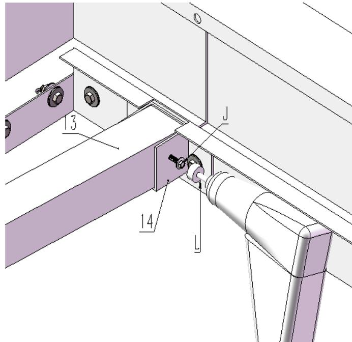
Dann die selbstschneidenden Schrauben der Halterung an den Seiten hereindre-
