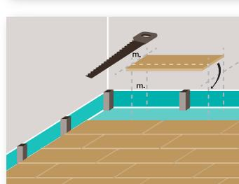
Corte y retire el trozo de marco para introducir sin problemas la lama por debajo de la moldura. Recuerde subir el underlay por las paredes unos 5 cm.
