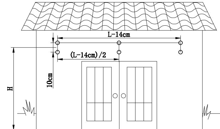
**TIPO DE MURO RECOMENDADO:** reforzado. Paredes de cemento, ladrillo o madera.
