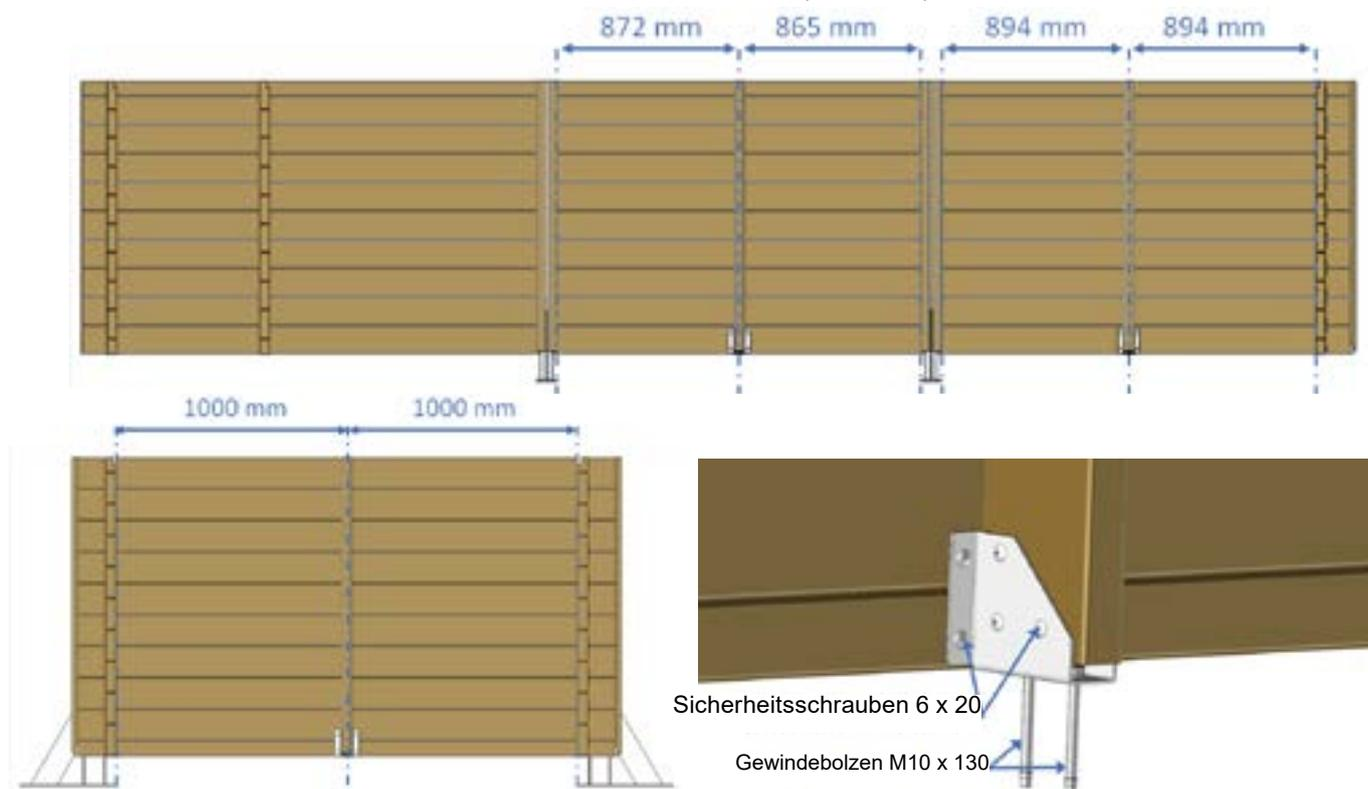
Abbildung 12 – Montage der Bodenanker für die Streben
