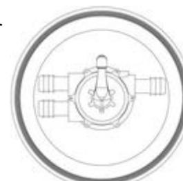
**NACHSPÜLEN:** Das von der Pumpe kommende Wasser wird von oben nach unten durch den Filter geleitet und zum Abfluss geleitet.
