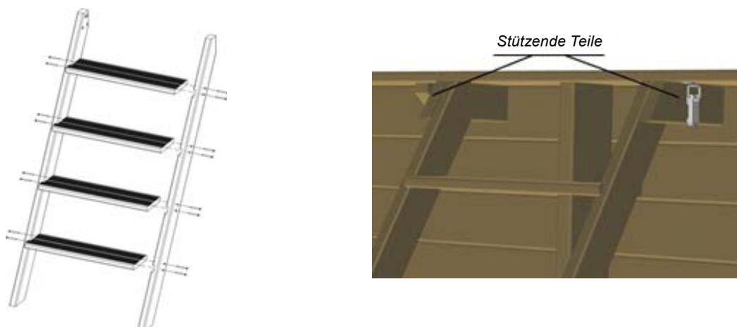
Abbildung 36 – Montage der Außentreppe aus Holz
