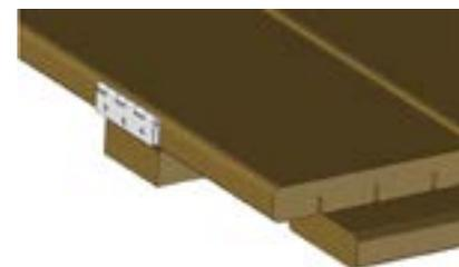
Abbildung 32 – Anbringen der Scharniere an den Holzrosten
