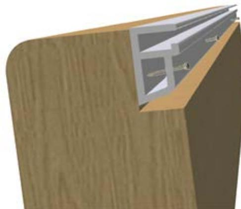
Abbildung 25 – Installation des Klemmprofils
