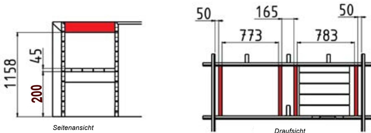
Abbildung 17 – Positionierung der Box-Stützstreben
