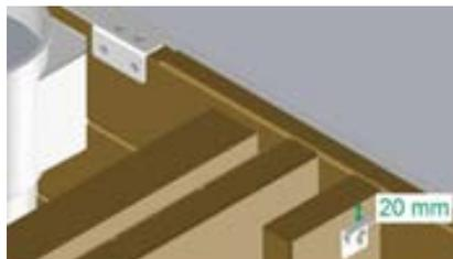
Abbildung 34 – Positionierung des Verschlussblechaufsatzes
