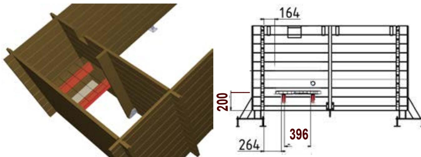
Abbildung 14 – Positionierung der Stützstreben des Box-Bodens
