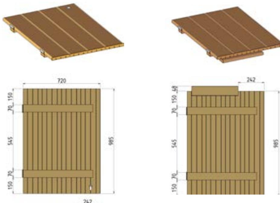
Montieren Sie den Holzrost mit Schloss. Verwenden Sie dazu 4 Handläufe mit den Abmessungen 985 × 180 × 28 mm, einschließlich des für den Durchtritt des Schlosses durchbohrten, und 2 Leisten mit den Abmessungen 650 × 70 × 28 mm.
