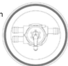
**GESCHLOSSEN:** Es ist keine Umwälzung möglich. Stellen Sie sicher, dass die Pumpe niemals in dieser Position arbeitet.
