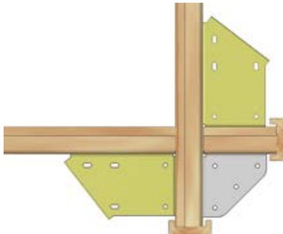
Abbildung 19 – Platzierung der Handlaufeckwinkel in den Ecken
