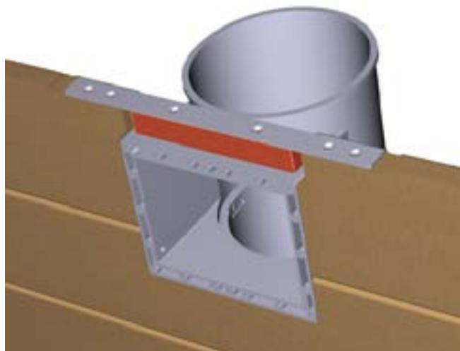
Abbildung 23 – Montage des Eckwinkels am Skimmer
