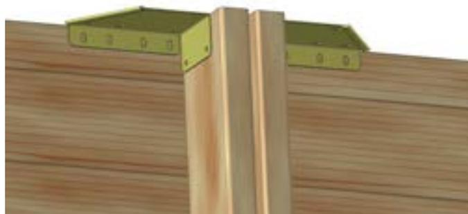
Abbildung 18 – Platzierung der Handlaufeckwinkel auf den Streben
