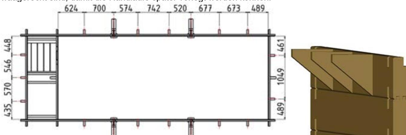
Abbildung 16 – Positionen der Holzkeile der Handläufe
