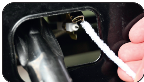
Pilootpõleti puhastamine šenilltraadi või piibuharjaga abil.
