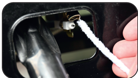
Pilotni gorilnik očistite s šenilsko žico ali čistilom za pipe.
