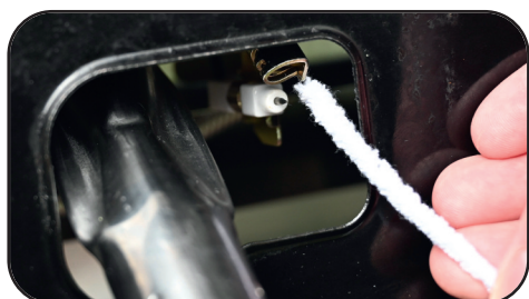
Vyčistenie pilotného horáka pomocou drôtu zo ženilky alebo čističa na píšťalku
