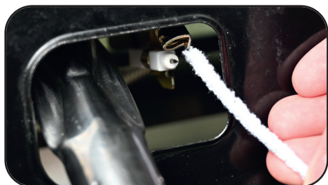
Neteja del cremador pilot amb l'ajut d'un filferro de xinilla o d'un netejapipes.
