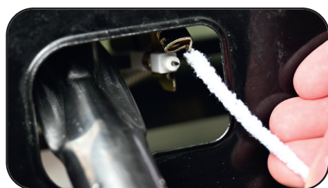
Nettoyage du brûleur pilote avec un fil chenille ou un nettoyant à pipe.
