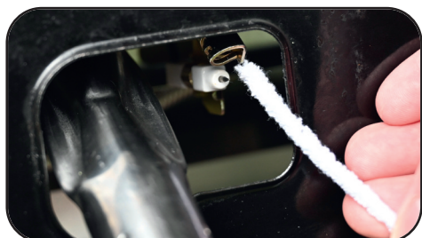
Rengör pilotbrännaren med en chenilletråd eller piprensare.
