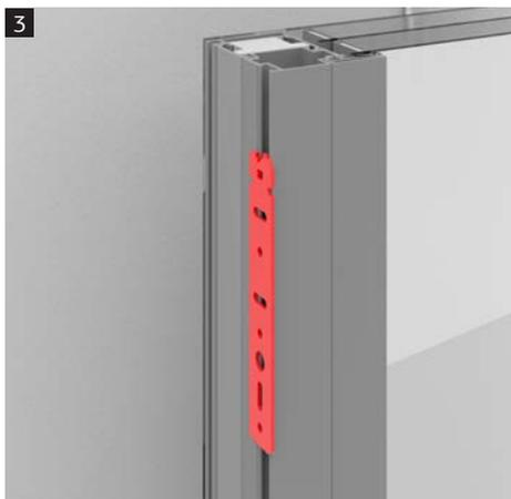
**4** Anker in die horizontale Position drehen, um ihn vollständig zu fixieren.
