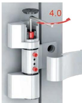
Vor dem Einstellen der Türbänder die Abdeckung der Türbänder entfernen und die Befestigungsschrauben von der Vorderseite lösen (wie auf dem Bild dargestellt). Nach dem Einstellen diese wieder befestigen.
