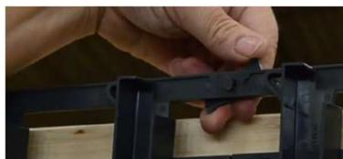
5. Setzen Sie die Sperrklinke an der Außenseite der Stangen ein und drehen Sie sie im Uhrzeigersinn.
