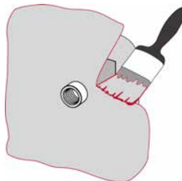
Bild 3: Aufbringen des oberen Dichtanstrichs
