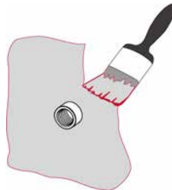
Bild 1: Aufbringen des unteren Dichtanstrichs
