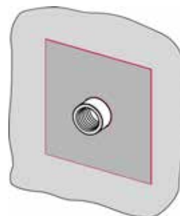
Bild 2: Dichtmanschette in noch feuchten Dichtanstrich einbetten
