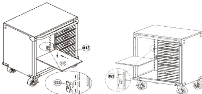
**Hinweis:** Der Einlegeboden benötigt Haken (#23) an allen vier Ecken zum Absichern. Bitte sicherstellen, dass die Haken alle auf der gleichen Höhe angebracht sind.
