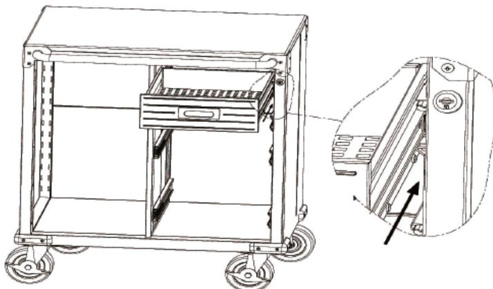
Die Kugellagerschienen so weit wie möglich ausziehen. Die Schienen der Schubladen nun vorsichtig auf den Kugellagerschienen des Rollwagens ansetzen. Vorsicht: Bei zuviel Kraftaufwendung können irreparable Schäden an den Kugellagerschienen entstehen!
