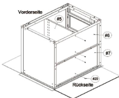
b. Das untere Rückteil (#6) zwischen linkem Seitenteil (#4) und rechtem Seitenteil (#3) einhängen. Mit Hilfe der Schrauben A (#20) und des Schraubendrehers (#24) das untere Rückteil (#6) an das obere Rückteil (#7), linkes Seitenteil (#4) an rechtes Seitenteil (#3) befestigen. Die Oberkante des unteren Rückteil (#6) ist dabei auf der Kante des oberen Rückteil (#7) – wie es der Aufkleber zeigt.
