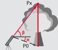
Laser auf die oberen Punkte richten. Das Winkel- / Höhentracking startet automatisch.
