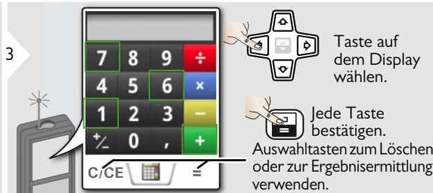
**i** Das Messergebnis aus der Hauptzeile wird in den Rechner übernommen und kann für weitere Berechnungen verwendet werden. Fuss/Zoll-Brüche werden in Fuss/Zoll-Dezimalwerte umgerechnet.
