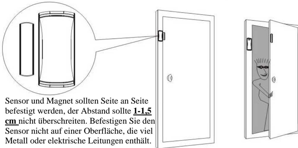
Sensor und Magnet sollten Seite an Seite befestigt werden, der Abstand sollte **1-1,5 cm** nicht überschreiten. Befestigen Sie den Sensor nicht auf einer Oberfläche, die viel Metall oder elektrische Leitungen enthält.
