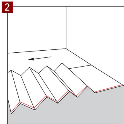
2 Die Unterlage wird auf dem sauberen und trockenen Unterboden mit der Dampfbremsfolie nach oben ausgerollt.
