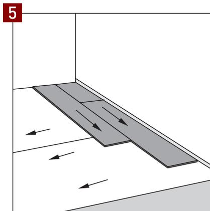
5 Verlegen Sie die Paneele quer zur Verlegerichtung der Unterlage. Beachten Sie die Anleitung des Oberbodenherstellers.
