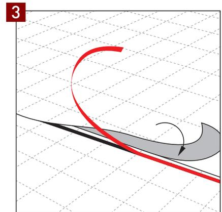
3 Entfernen Sie den Schutzstreifen und verbinden Sie die einzelnen Bahnen mit der Überlappung um eine durchgängig dampfbremsende sowie stabile Oberfläche zur Montage des Bodens zu erhalten.
