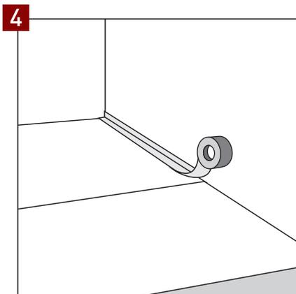
4 Die Unterlage muss an der Wand mit dem Alu-Klebeband verklebt werden, um eine vollflächige Wirkung der Dampfbremse zu erzielen.
