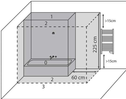
**AVERTISSEMENT:** Ce produit doit être installé uniquement aux niveaux 2 et 3 d'une salle de bain selon la réglementation d'installation. Nous vous suggérons de faire appel à un électricien professionnel pour obtenir de l'aide.
