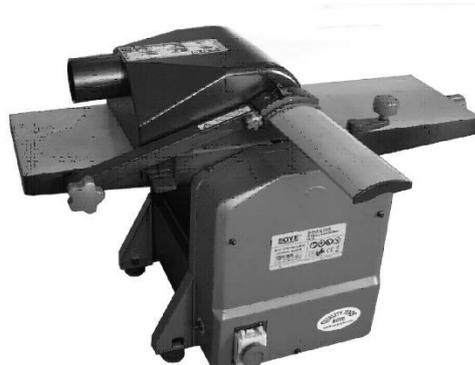
Odsávací hubice se ke stroji připevňuje pomocí dvou spon, kterými se připevní na srovnávací stůl. Při srovnávání hubici připevněte pod stůl, aby hobliny mohly být spodem odsávány. Při tloušťkování odmontujte kryt válce a nasadte hubici do připravených vyfrézování ve stole.
