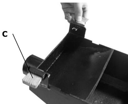
U tu svrhu stol blanjalice **B** spustite u najniži položaj. Sada plastične spojnice **C** odsisnog adaptera povucite prema van. Pozicionirajte odsisni adapter i utisnite spojnice **C** u za to pre-videne utore **A** na izlaznom stolu za ravnanje.
