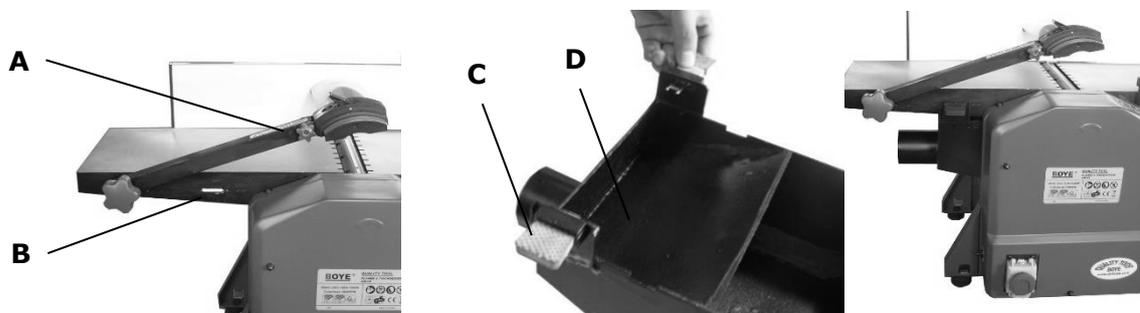
Zdvihnite rameno z ochranného krytu hoblňovacieho valca **A**, až kým sa neobjavia drážky **B**. Teraz vytiahnite plastové úchytky **C** odsávacej hubice smerom von. Hrúbkovaci stol umiestnite do najnižšej polohy a vložte odsávaciu hubicu. Saciu hubicu umiestnite tak, aby boli obidve
