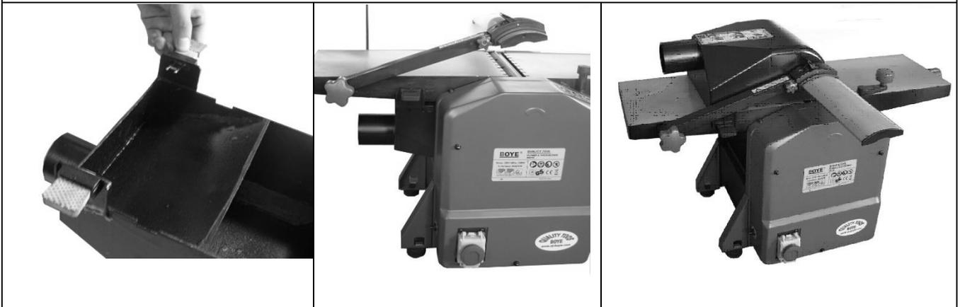
La hotte comporte deux brides qui peuvent être fixés à la table. Pour le dégauchissage, installer la hotte sous la table, de sorte que les copeaux sont absorbés par le dessous. Pour le rabotage enlever la protection de la tête de coupe et puis placer la hotte dans le creux de la raboteuse et la fixer avec la bride dans la fente correspondante.
