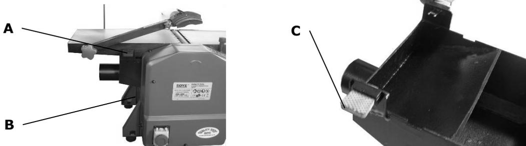
Baje la mesa del regrueso **B** a su posición más baja. Tire de las pestañas de plástico **C** del adaptador de la campana hacia fuera. Ahora coloque la campana y apriete las pestañas **C** en las ranuras correspondientes **A** en la mesa de salida del cepillo.
