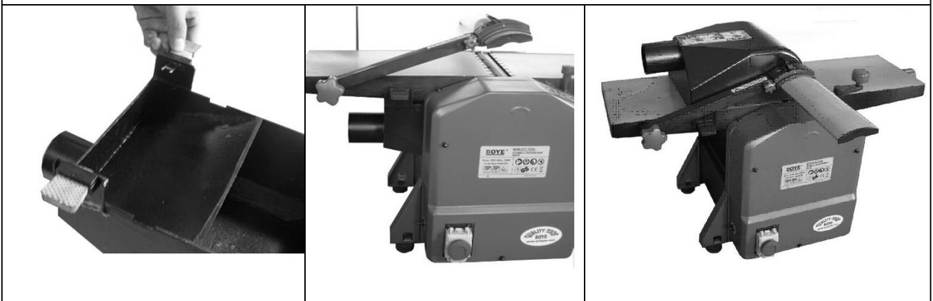
La campana de aspiración tiene dos bridas con las cuales se puede unir a la mesa. Para el cepillado, instale la campana debajo de la mesa, para que las virutas sean absorbidas desde abajo. Para el regreso, quitar la protección del cabezal de corte y colocar después la campana en el hueco del regreso y fijarlo con la brida de nuevo en la hendidura correspondiente.
