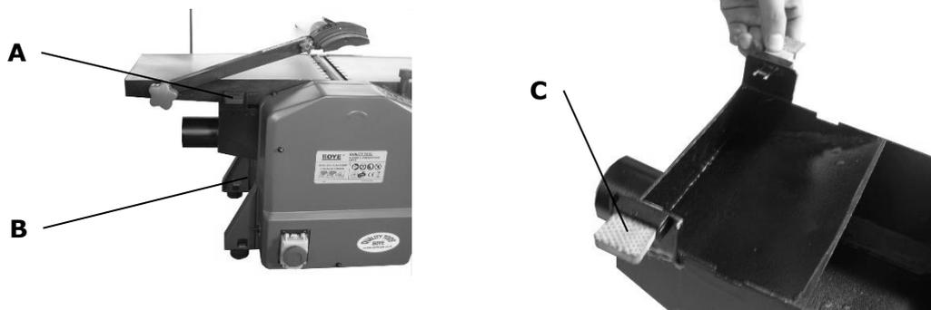
Nastavte tloušťkovací stůl do nejnižší polohy **B**. Vytáhněte plastické spony **C** ven. Umístěte hubici do spodní polohy na stůl a zamáčkněte spony **C** do příslušných vyfrézování **A** na srovnávacím stole.
