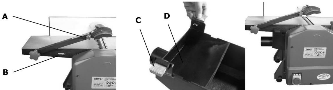
Heben sie den Arm von der Hobelwellenschutzabdeckung **A**, bis die Schlitten **B** zum Vorschein kommen. Ziehen Sie nun die Plastiklaschen **C** der Absaughaube nach außen. Positionieren sie den Dickenhobeltisch auf die unterste Position und schieben sie Absaughaube ein. Die Absaughaube so positionieren dass beide Laschen C mit den Schlitten B ausgerichtet sind. Die Laschen **C** in die Schlitte **B** am Abricht-Ausgangstisch drücken.
