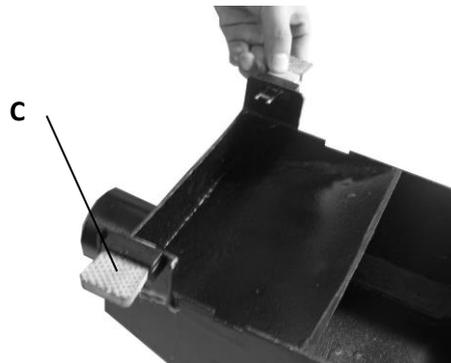
Abaissez la table de raboteuse **B** à sa position la plus basse. Tirez des onglets de plastique **C** de l'adaptateur de la hotte vers l'extérieur. Maintenant, placez la hotte et appuyez les onglets **C** dans les rainures **A** en la table de sortie de la dégauchisseuse.
