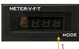
Durch Betätigung der Taste (1) kann zwischen den einzelnen Modi gewechselt werden: / By operating the key (1), you can switch between the individual modes:
