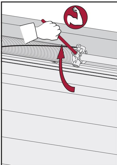
**6.1.3.** Introduzca la 2ª herramienta de tensado hasta el fondo del siguiente orificio de tensión.
