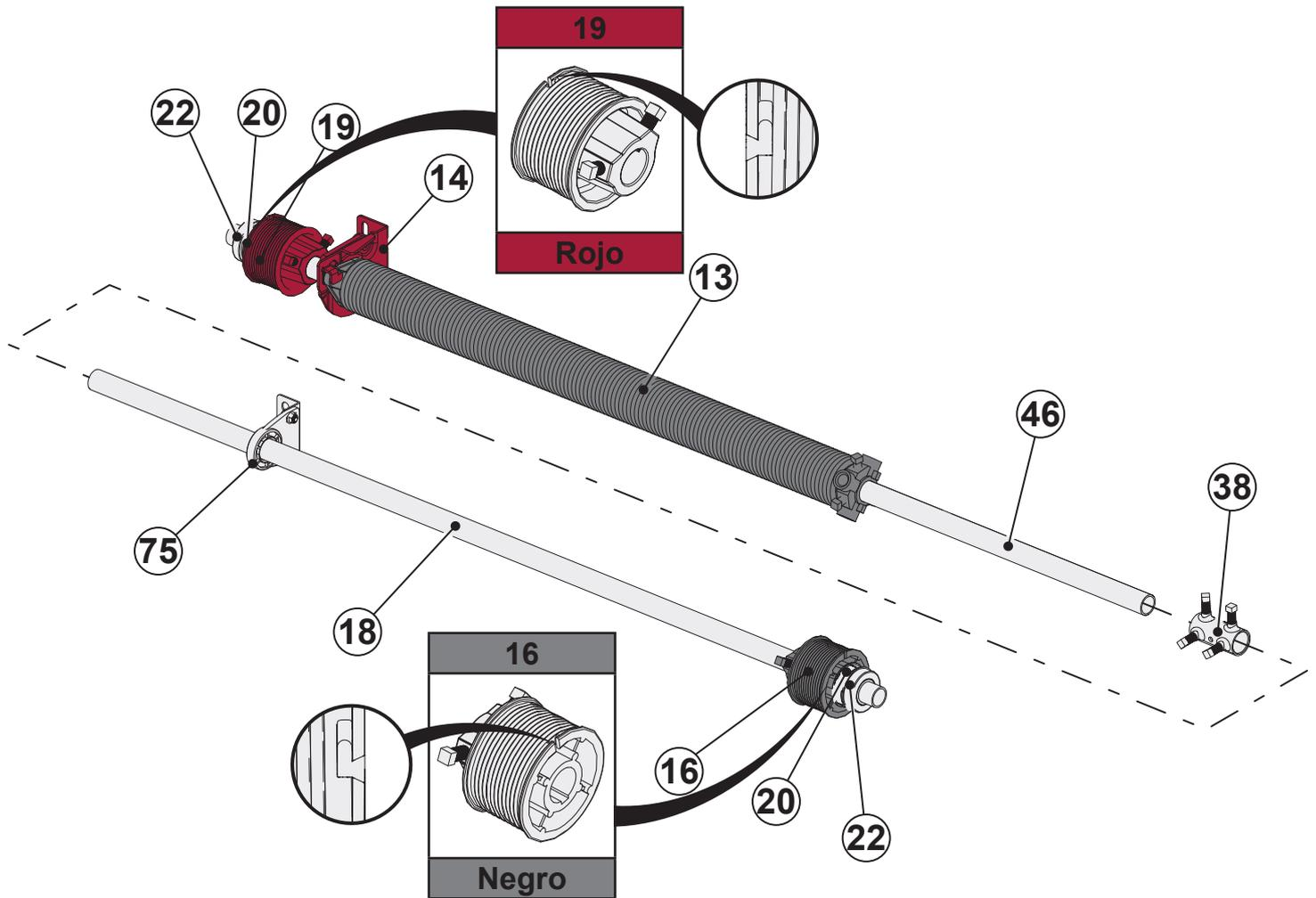
3.1.3 Apretar los 4 tornillos de la unión del eje (38).
