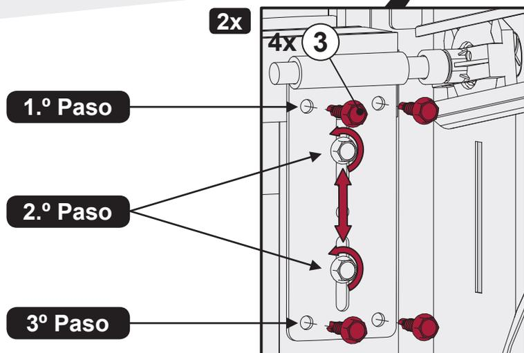
**1.º Paso** Aflojar los dos tornillos centrales de la bisagra superior (23).
