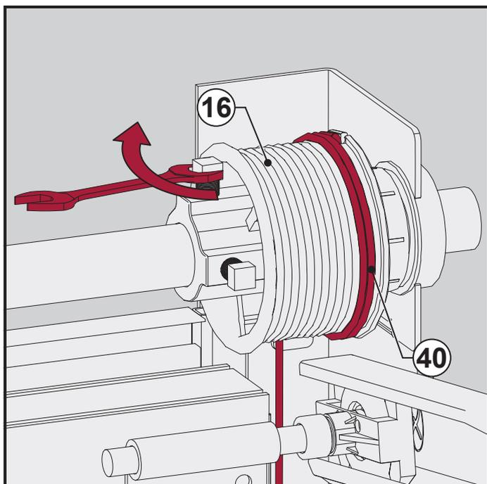
5.4 - Asegure el eje con un alicate de apretón, asegurándose de que el cable está tenso (sobre tensión).
