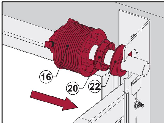
3.2.3 Empuje los rodamientos de PVC (20) contra los rodamientos de metal (22).
