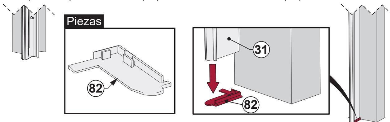
2.4.2 Posicionamiento de la guía de conexión (30) en la parte inferior de la primera cantonera (32) como se muestra en el diagrama, de seguida la posición de la segunda cantonera (31).
