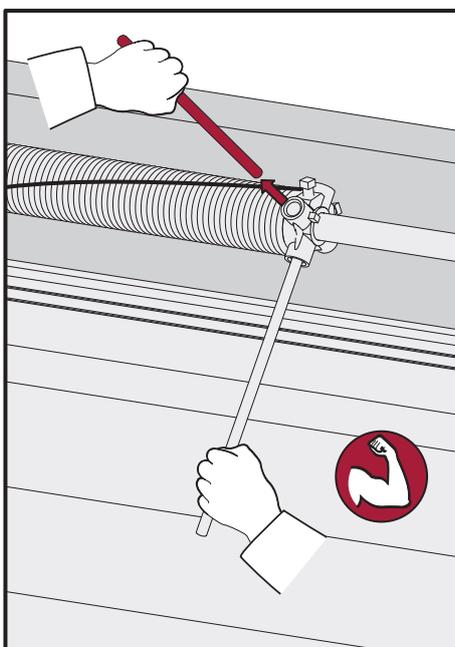
**6.1.6.** Gire la 2ª herramienta de tensado ¼ de vuelta, de modo que el muelle que sometido a tensión.
