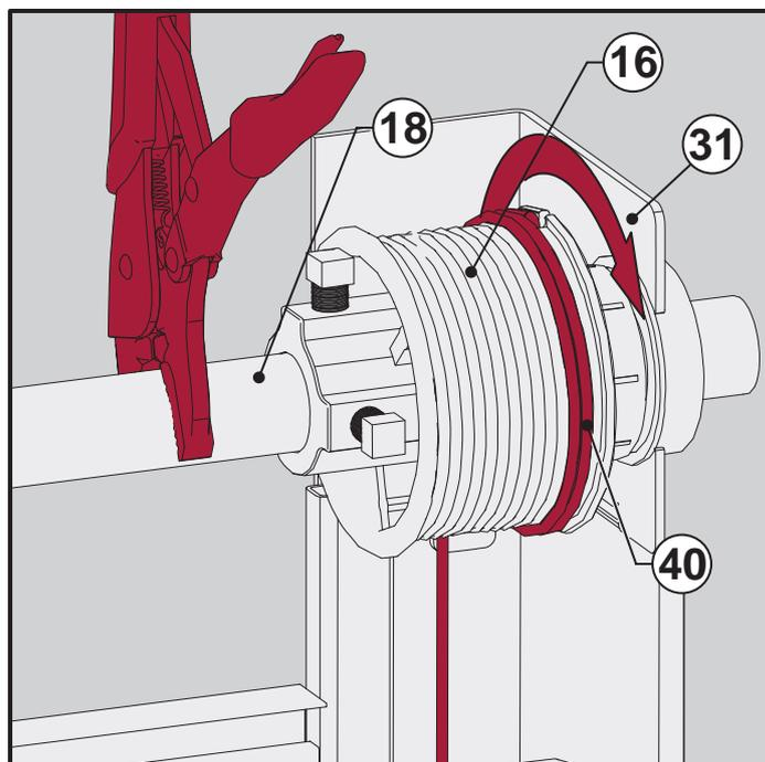
Repita el proceso con el segundo cable y la polea (19). Asegúrese de que ambos cables se insertan en las ranuras.
