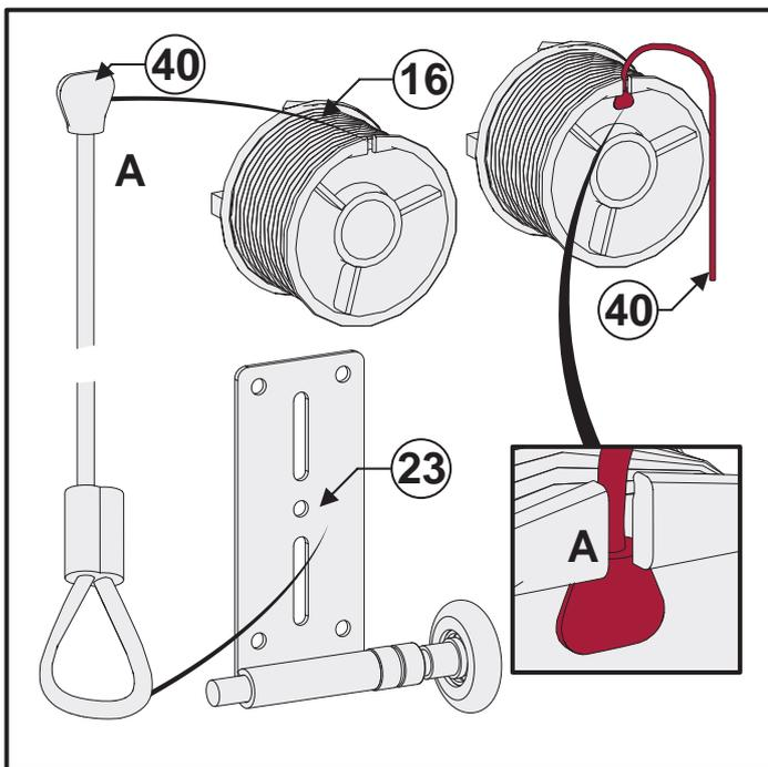
5.2 - Asegure el eje con un alicate de apretón. Enrollar el cable de acero (40) alrededor del tambor (16) hasta que el cable quede tenso.
